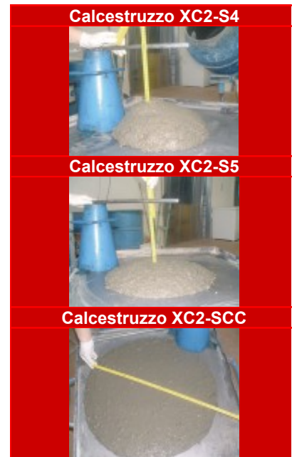
Figura 1 – Tipiche Consistenze del "Calcestruzzo XC2" allo stato fresco. La scelta della Consistenza è di fondamentale importanza per evitare difetti di costipazione (ex. vespai) ed è funzione delle difficoltà esecutive oltre che dell'affidabilità della manodopera in cantiere.
